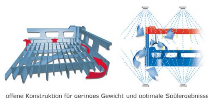
offene Konstruktion für geringes Gewicht und optimale Spülergebnisse
